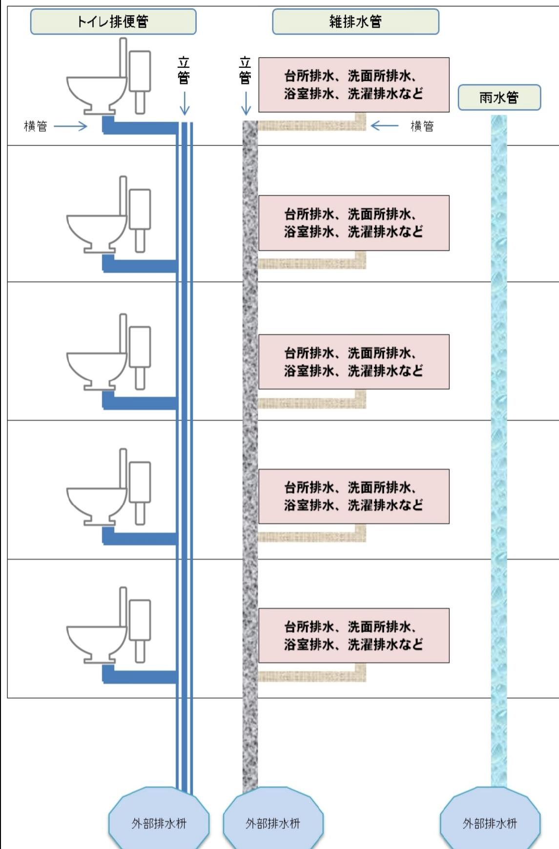
※外部排水枠から先の流れは、団地により異なります。公共下水に流れる団地もあれば、浄化槽により処理される団地もあります。
